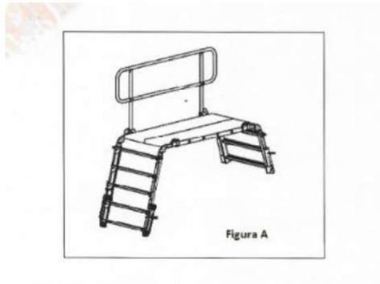
2.6. Os trilhos de acoplamento dos lances deverão possuir sistema de travamento, tipo pino trava, dispensando o uso de ferramentas;
