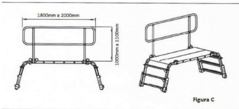
2.10. A plataforma quando montada deverá suportar a capacidade mínima de carga de 400 kg;
