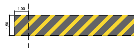
ONDULAÇÃO TRANSVERSAL TIPO B - SINALIZAÇÃO HORIZONTAL SEM ESCALA - COTAS EM METROS
