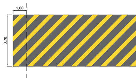
ONDULAÇÃO TRANSVERSAL TIPO A - SINALIZAÇÃO HORIZONTAL SEM ESCALA - COTAS EM METROS
